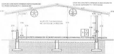
CORTE LONGITUDINAL X-2 ESC. 1:75
